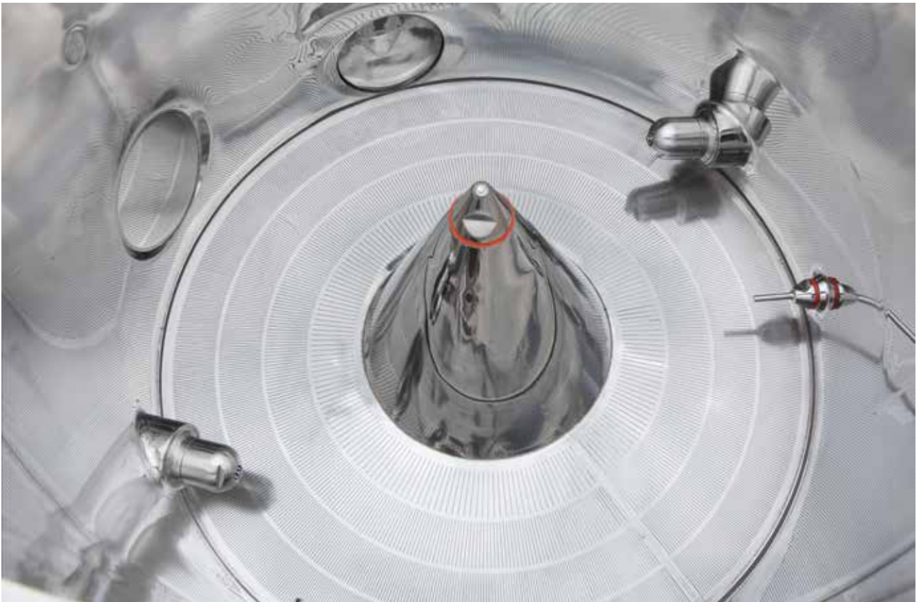
Bohle Uni Cone BUC® - Anströmboden mit tangential angeordneten Sprühdüsen.
