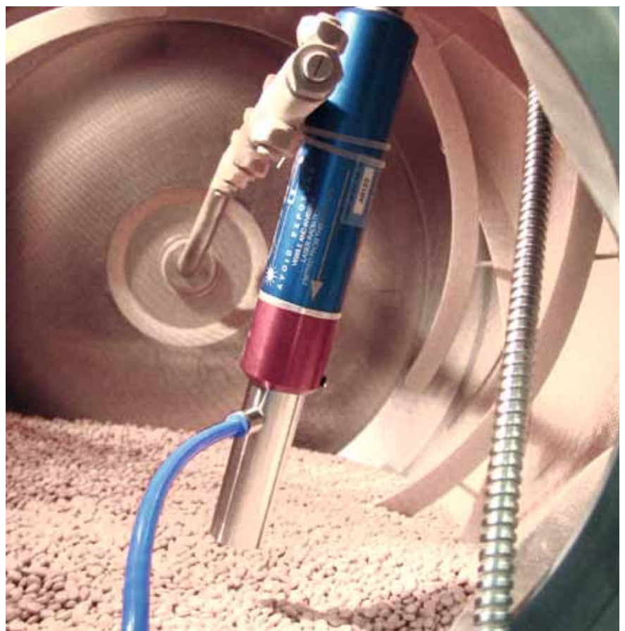
Abb. 2: BFC 50 Tripan mit eingebauter PhAT-Sonde
