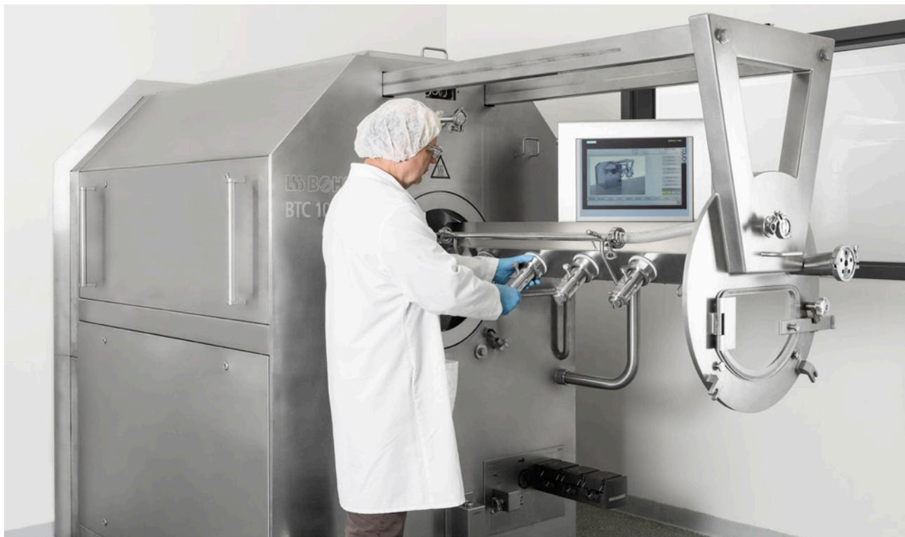
**Der Bohle Tablet Coater BTC steht für wirtschaftliches Tablettencoating. Ein flaches Tablettbett, patentierte Luftführung und hohe Sprühmengen sichern die Qualität und verkürzen die Prozesszeiten um bis zu 35 %.**
