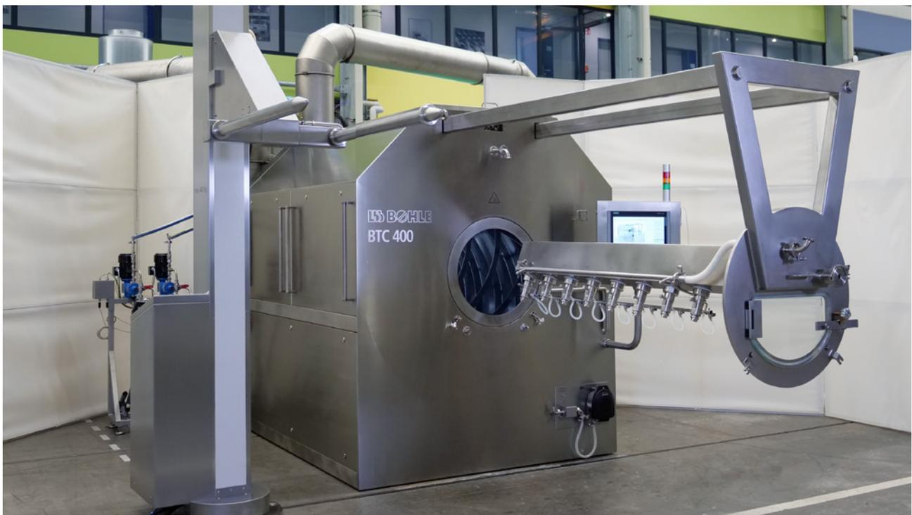
*Der BTC 400, hier mit Hubsäule der SL-Baureihe, ermöglicht bis zu 35 % kürzere Prozesszeit im Vergleich zu herkömmlichen Coating-Systemen.*
